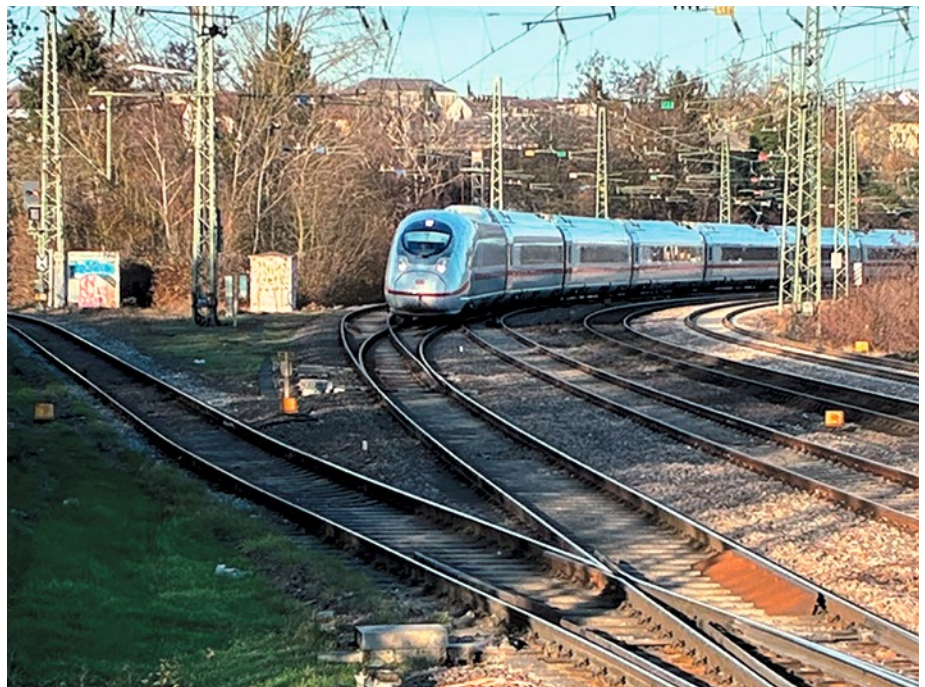
Abb. 2: Die Weichen nahe der Betriebsstelle „Saardamm“ bei Saarbrücken zwingen u. a. den ICE Richtung Paris über rund 2 km lang nur mit 60 km/h statt \geq 80 km/h zu fahren. Quelle: W. Ried
